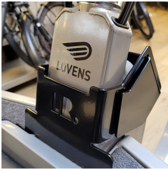
3.3 Monteer de schuif in de beugel en bevestig het Abus Diskus slot.
